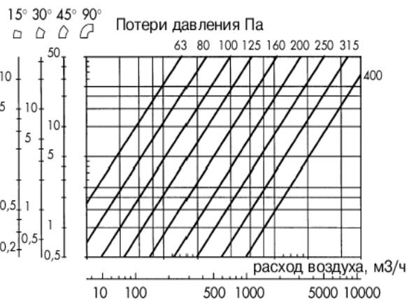
Диаграмма 5. Сопротивление изгибов каналов воздушной вентиляции
