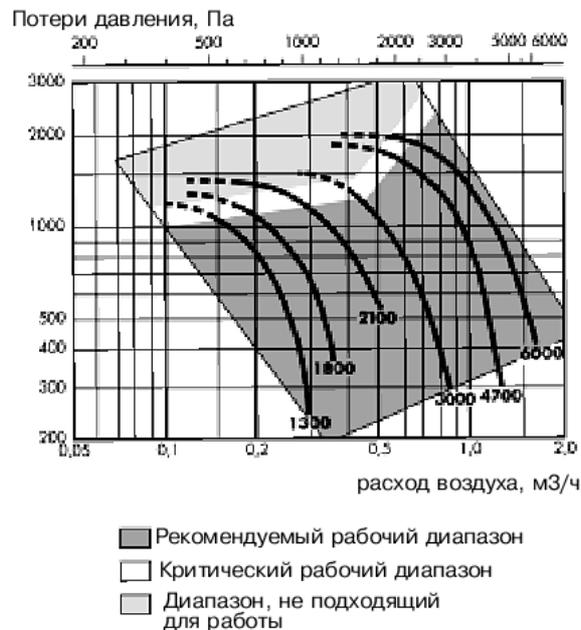
Диаграмма 6. Графическая зависимость потерь давления для вентиляторов
