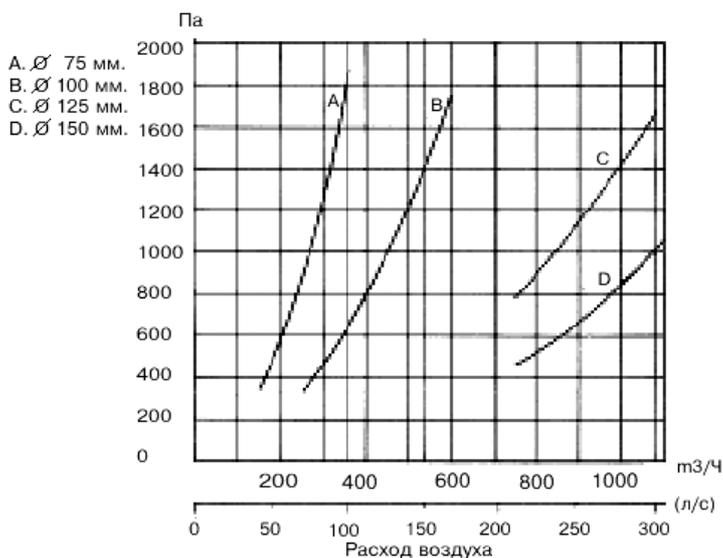
Рис. 1 Давление воздуха в шланге и каретке.
